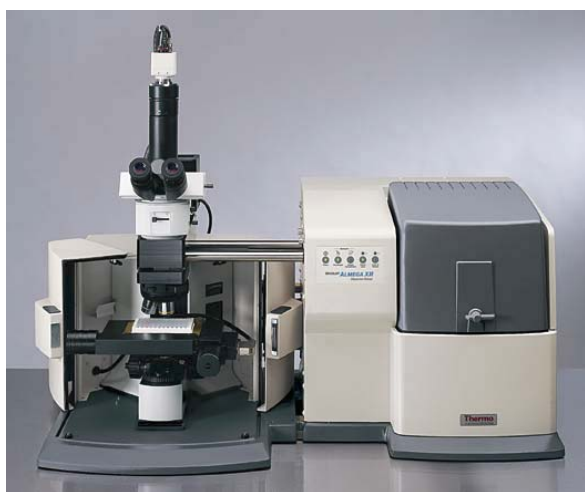
図1 Nicolet Almega XR 顕微ラマン分光装置
