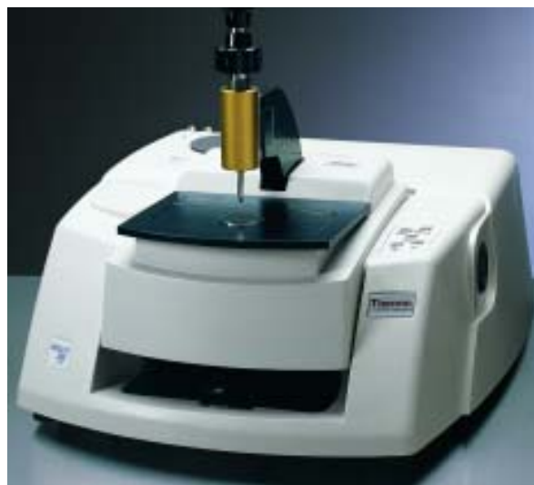
図2 FT-IR ATR システムの構成例 (Nicolet 380 FT-IR + Smart Orbit ダイヤモンドATR)
