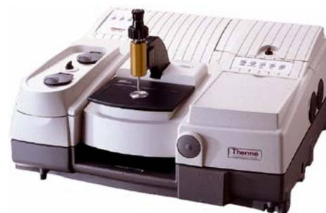
図3 フーリエ変換赤外分光装置 Nicolet™ 6700 FT-IR + Smart Orbit 1回反射型ATRアクセサリ
