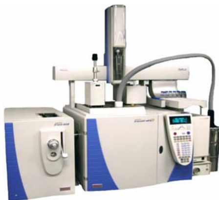
図2 TRACE DSQ™ 四重極型ガスクロマトグラフ質量分析計 (GC/MS)
